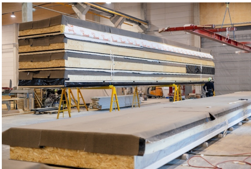
Kuva 32. Valmis kattoelementti. (Lapwall Oyj)
