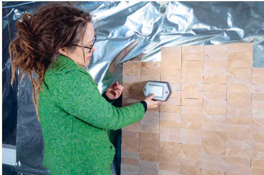
Milla Sairanen testaa poikkisyyhyn leikatun puupinnan kykyä sitoa ja luovuttaa kosteutta. Milla Sairanen tests the ability of a cross cut wood surface to absorb and release moisture.
