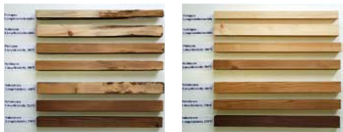
Puut ennen koetta ja kuusi vuotta koekentässä olon jälkeen.
