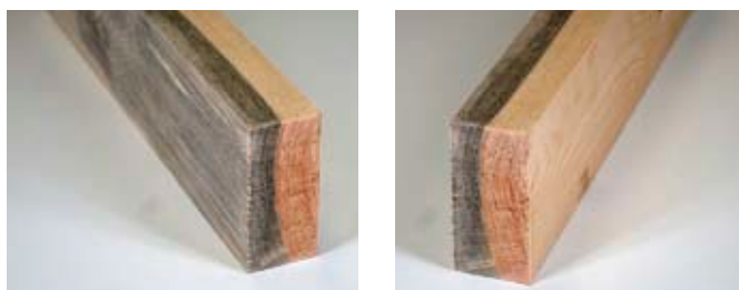
Sydänpuu kestää sinistäjäsiementen voimakkaan rynnistyksen. Sama lankku kuvattu sekä pintapuun että sydänpuun puolelta.
